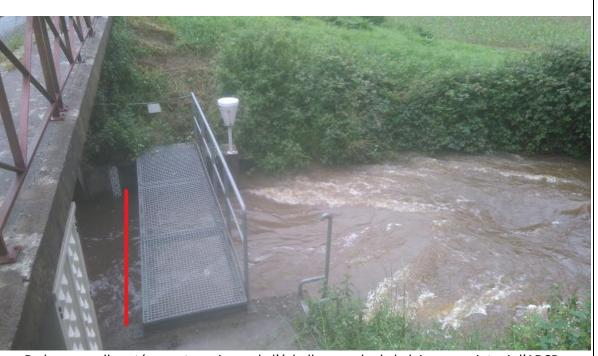
De la passerelle coté amont au niveau de l'échelle, prendre le balai pour maintenir l'ADCP
